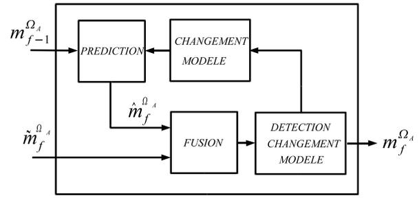
Figure 2 – Principe du filtre temporel crédibiliste où  $\hat{m}_f^{\Omega_A}$  est la prédiction,  $m_f^{\Omega_A}$  est la valeur de sortie du filtre à l'image  $f$  donnant l'état de l'action et  $\tilde{m}_f^{\Omega_A}$  est la mesure en sortie de la fusion de paramètres à l'image  $f$ .
