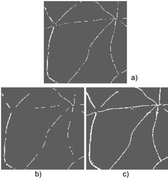
**Figura 6:** a) zonas extraídas; b) eliminación de regiones basada en área; c) Resultado del crecimiento de regiones.
