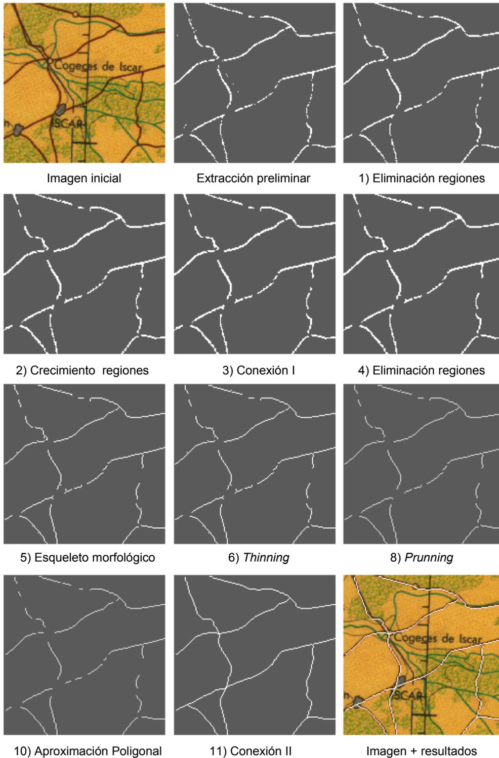
**Figura 4:**Fases principales del procedimiento de refinamiento de la información (ver texto).
