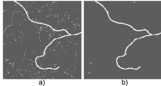
**Figura 5:** a) zonas extraídas; b) eliminación de regiones basada en área
